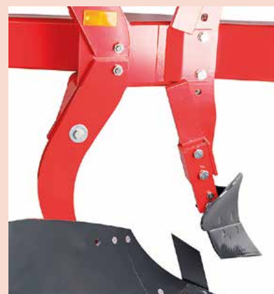
Skärbult: 16 mm 10.9 bultkvalitet, brister vid en kraft av 4 000 kg.
